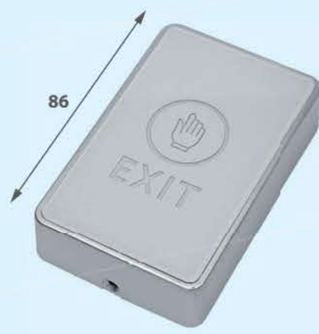
PW-C3 - Biały Materiał wykonania: plastik Wymiary: 86 x 56 x 21 mm Podświetlenie LED Wyjście: NO/NC/COM
