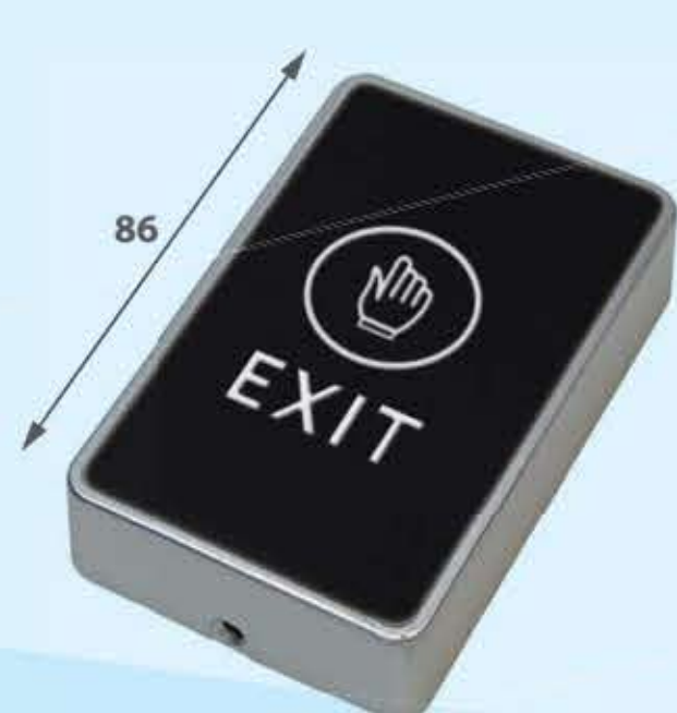
PW-C1 - Czarny Materiał wykonania: plastik Wymiary: 86 x 56 x 21 mm Podświetlenie LED Wyjście: NO/NC/COM
